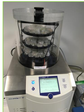
Liofilizzatore da laboratorio ALPHA 1-4 D plus Christ
